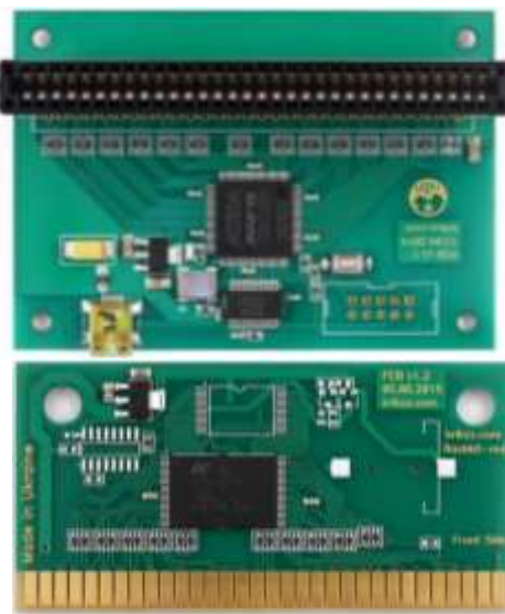
Figura 4.41: Programador i PCB de Krikzz
