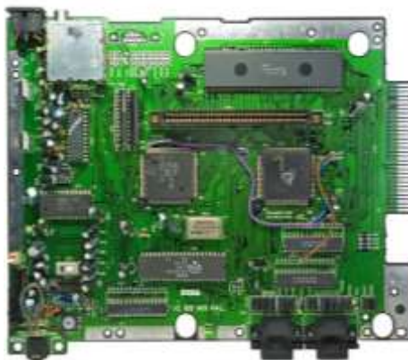
Figura 2.2: Placa base Mega Drive model europeu
